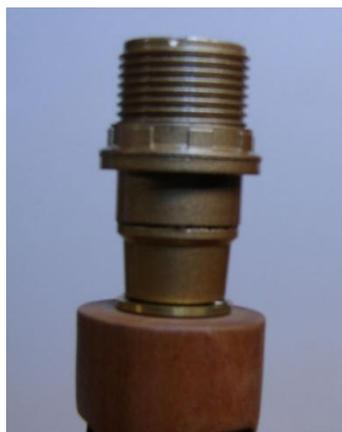
Dans le cas d'un pied plus long vous pourrez utiliser le perçage avec un fleuret ou une mèche plus longue mais je préconise toujours un perçage par retournement, si par malheur vous n'êtes pas vraiment dans l'axe la jonction ce fera à l'intérieur du pied. L'utilisation d'une lunette pour un maintien plus sécurisé est conseillé.
